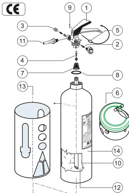
\*\* Marchiatura serbatoio: (Ente di Sorveglianza) CE 1370, produttore serbatoio, decimale anno produzione, (Codice identificativo produttore) 0095, n° matricola serbatoio, (Pressione di collaudo) PT xx Bar.
